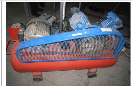
V벨트 안전덮개 설치(예)
