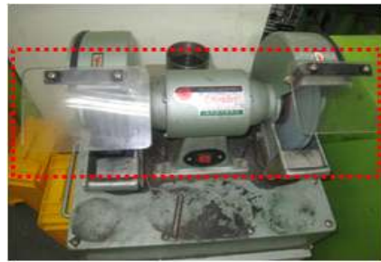
연삭숫돌 상부 안전섀드 설치(예)
